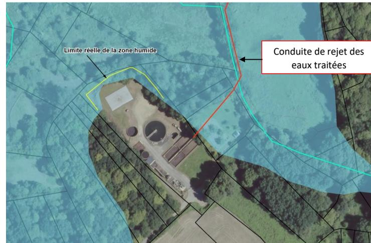
Figure 36 : Reprise de la limite réelle de la zone humide en fonction du remblai (Biosferenn)
